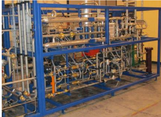
Bild 5: Ausschnitt der transkritischen CO 2 -Kälteanlage mit drei Ejektoren. (Quelle: Enex Srl)
