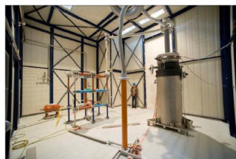
Abb. 11. Hochspannungsstation für die Tests für den 154 kV Strombegrenzer von KEPRI (Korea).
