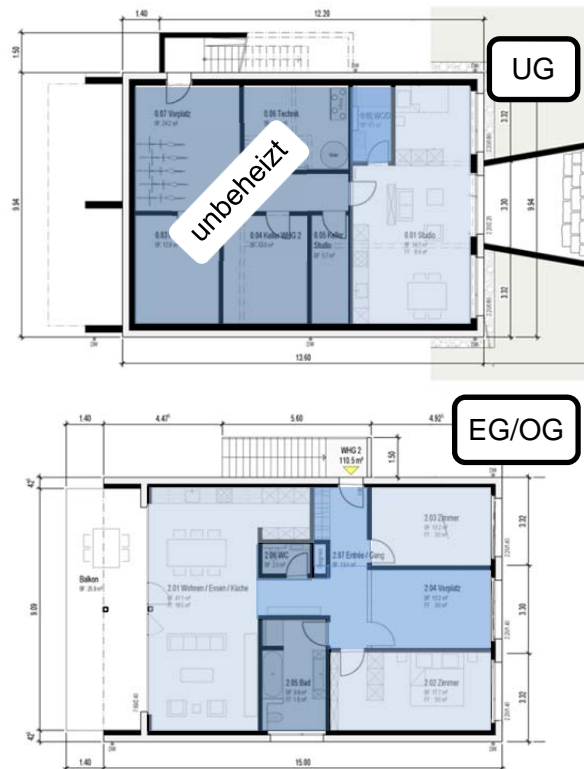
Bild 8: Aufteilung der thermischen Zonen, Foto und Modell des Gebäudes.
