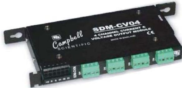
« Le module SDM-CV04 a 4 voies de sorties indépendantes ; il est prévu pour permettre à la centrale de fournir un courant ou une tension variable, sous le contrôle du programme de la centrale de mesure. La centrale de mesure peut être configurée soit en sortie tension 0 à 10 V CC ou en boucle de courant (0 à 20 mA). Les sorties courant peuvent être paramétrées et limitées de 4 à 20 mA. »
