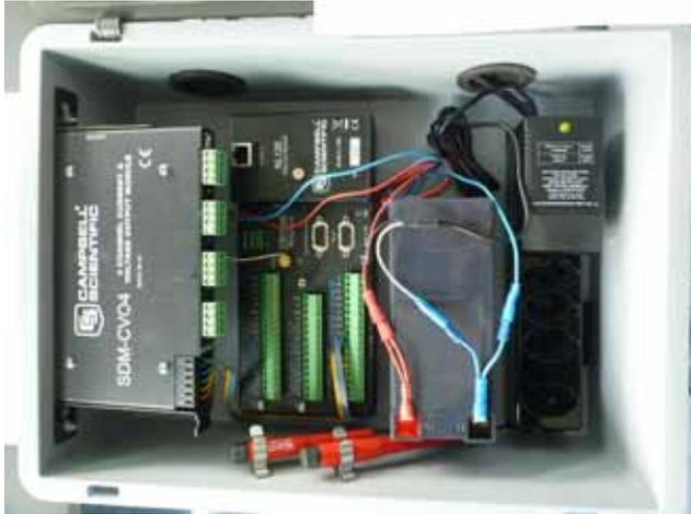
Figure 5.2 Coffret contenant l'acquisiteur, l'unité de contrôle analogique et l'alimentation
