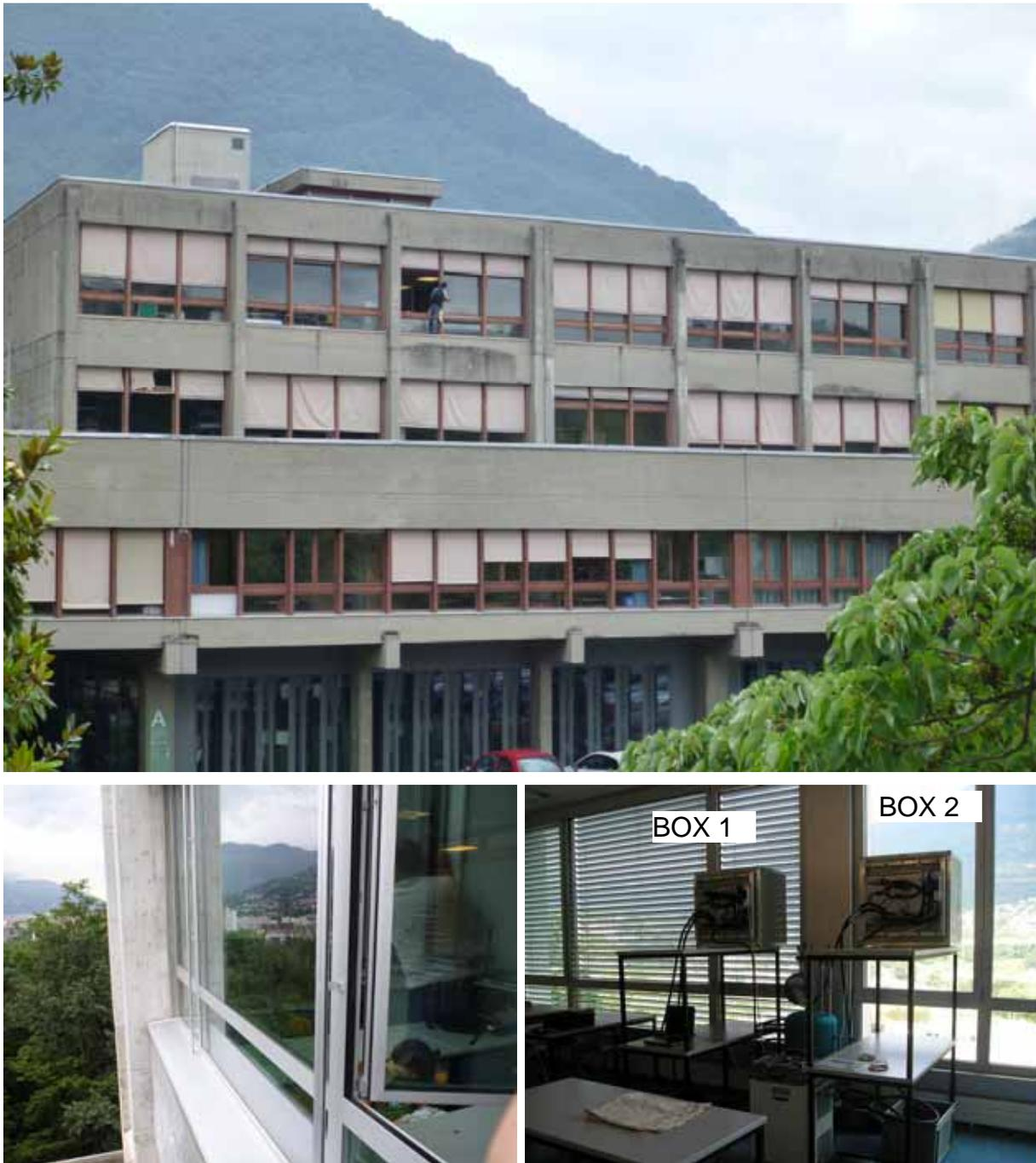
Figure 8.2 Placement du dispositif g-box dans la salle de cours A204 de la SUPSI à Trevano. Pour le box 1 à gauche, la situation montrée correspond aux stores baissés avec inclinaison des lamelles à 45°.
