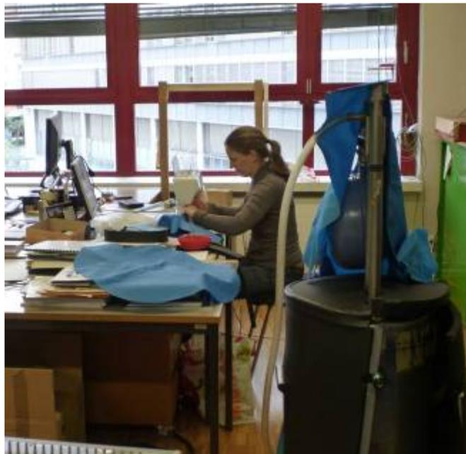
Réservoir terminé et équipé de son vase d'expansion avant isolation. A droite, confection de l'isolation en mousse néoprène habillé de tissu Cordura cousu sur mesure.
