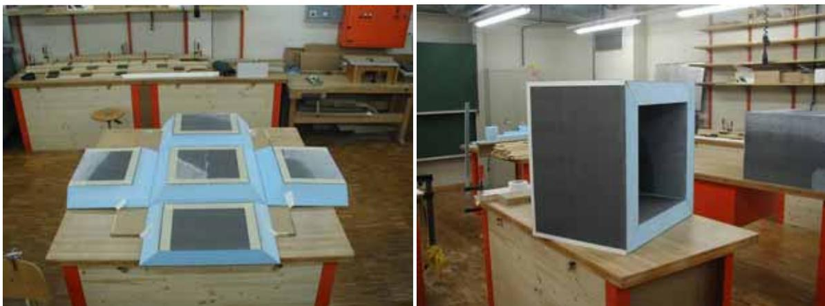
Figure 4.3 Fabrication du caisson thermique.
