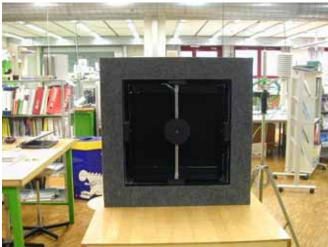
Figure 4.5 Boite thermique finie avec sondes de température entre l'absorbeur et l'échantillon (disque de protection de la sonde de température contre rayonnement solaire direct).
