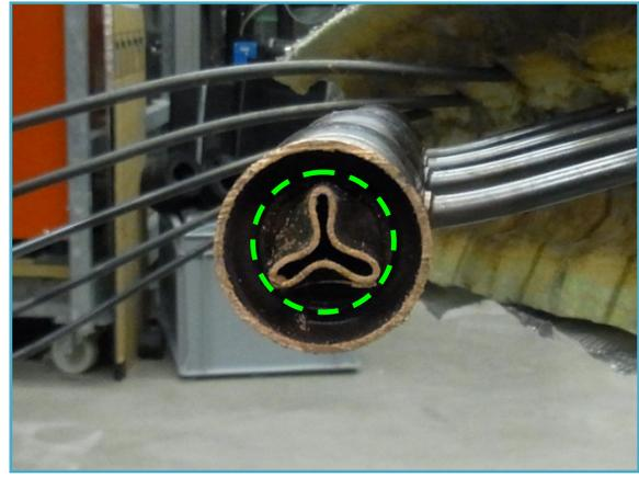
Abb. 11 (links): Neuartige Heatpipe Konstruktion: Der Kondensator ist nicht wie üblich in das Sammelrohr eingeführt sondern umschliesst das Sammelrohr von aussen.
