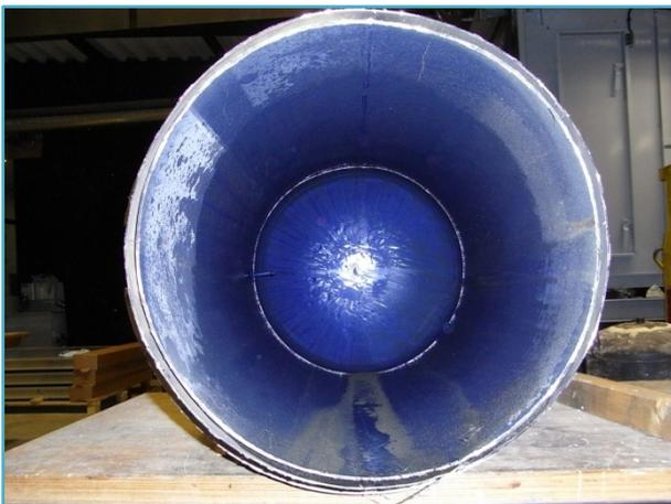
Abb. 17: Endkontrolle an einem emaillierten Thermosiphonspeicher zum Abschluss der Qualitätsprüfung. Dies dient einerseits dazu, die Masse der Komponenten (z.B. Dicke der Speicherwand) für die Solar Keymark Überwachungsprüfung zu erheben und andererseits auch um die Materialien und deren Qualität abschliessend zu bewerten.
