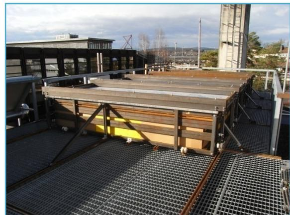
Abb. 22: Die Anlage wird geschlossen und das Luftkissen auf den vorbestimmten Druck geregelt.
