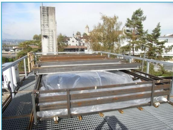
Abb. 21: Belastungstestanlage geöffnet. Im Vordergrund ist das aufblasbare Luftkissen sichtbar. Der Kollektor liegt unter dem gefüllten Luftkissen zur Prüfung der Schneelast.
