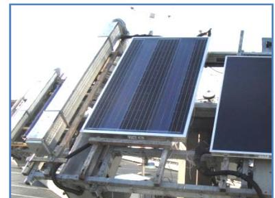
Auswahl von PVT Kollektoren die am SPF gemessen wurden. Die PV-Module links (Abb. 4) und in der Mitte (Abb. 5) werden direkt als Absorber genutzt. Der Kollektor rechts (Abb. 6) ist ein konventioneller thermischer Kollektor der mit einer modifizierten Abdeckung versehen wurde (erster Solar Keymark zertifizierter PVT Kollektor).
