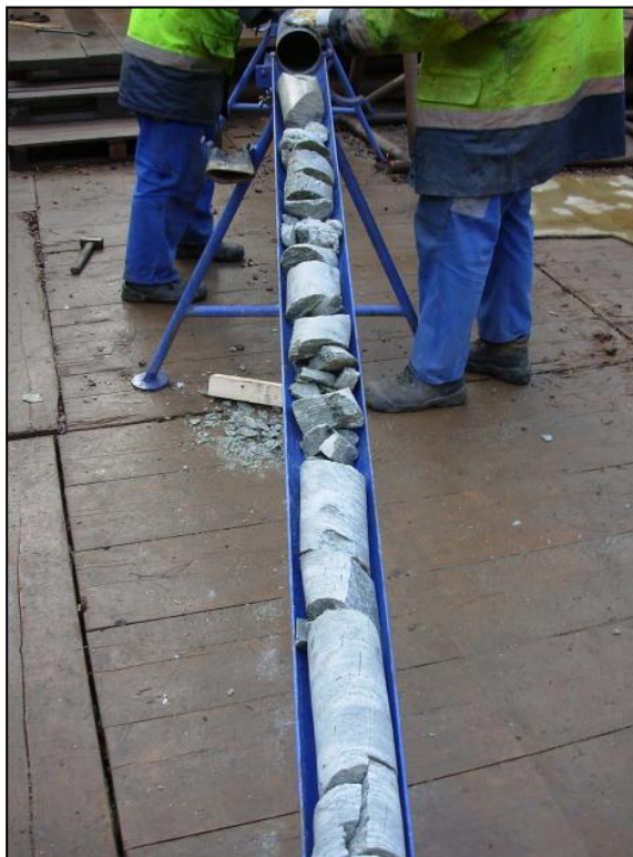
Figur 18: Aufnahmen eines Bohrkern (Gneise Kristallin Aare-Massiv) aus 08-BR1 (links), faseriger Aktinolith aus einer Kluftfläche aus 10-BR2 (nach Norbert 2010)
