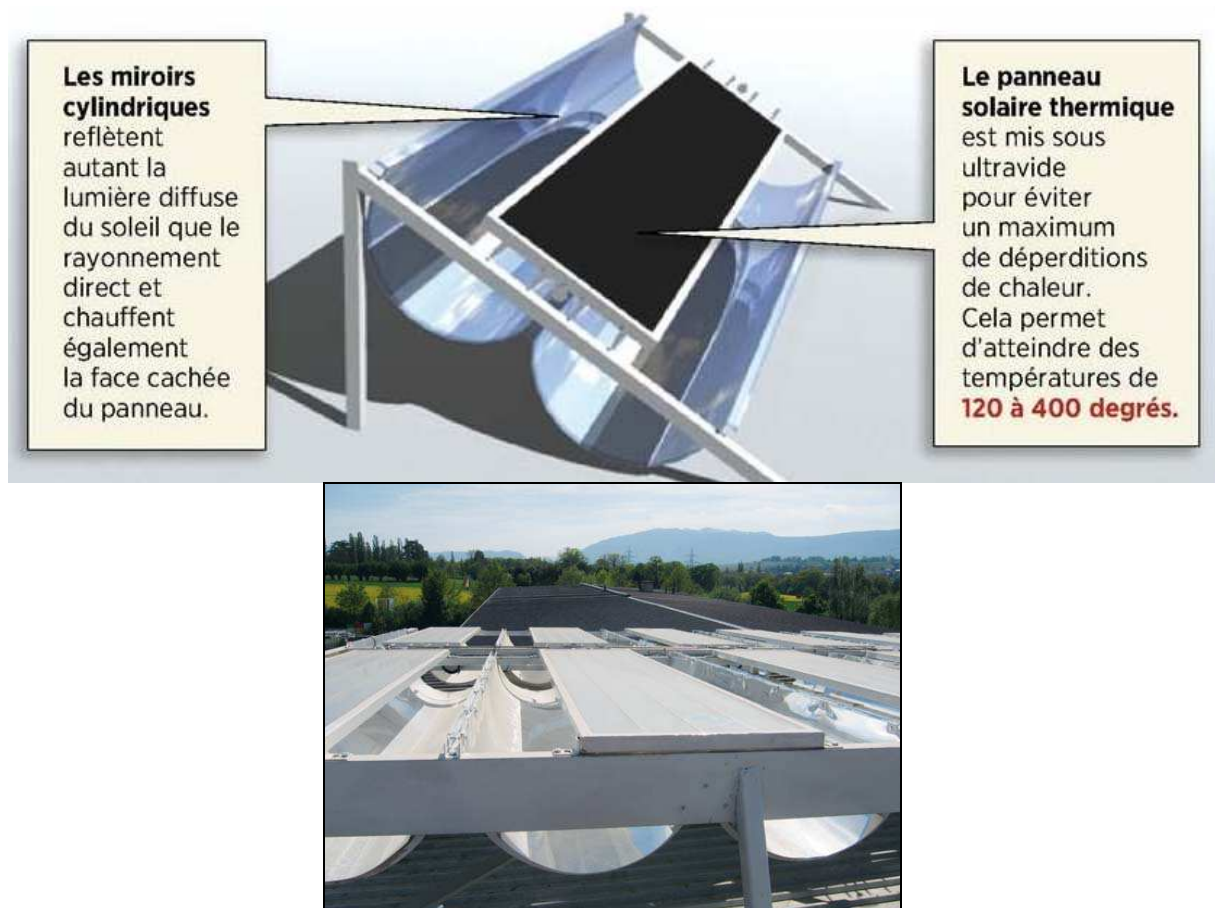
Figure 2 : Panneau solaire avec les miroirs cylindriques réfléchissant
