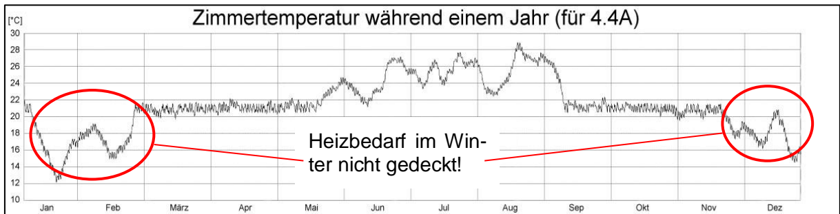
Abb. 36: Wenn die WP nur in der Nacht mit Niedertarif Strom betrieben wird (Variante 4.4A), kann der Heizbedarf im Winter nicht genügend gedeckt werden. Das Speichervolumen müsste dazu vergrössert werden
