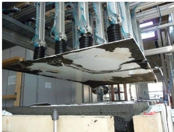
Bild 21 Zugmaschine für Belastungstest, Eingespanntes Glas-Glas Modul nach Versagen (Quelle: SUPSI).
