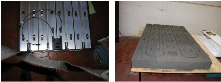
Bild 5 links: Hybridmodul der Firma 3S, rechts: Fomaglas mit Aussparungen für die Verklebung (Quelle: Pittsburgh Corning (Schweiz) AG).
