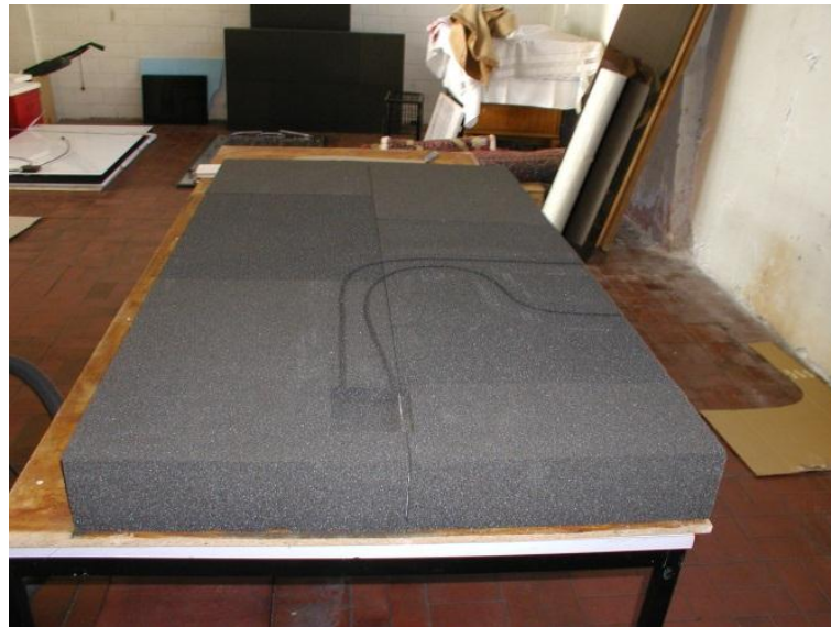
Bild 22 Zusammengeklebte Foamglasblöcke im Modulformat (Quelle: Pittsburgh Corning (Schweiz) AG).
