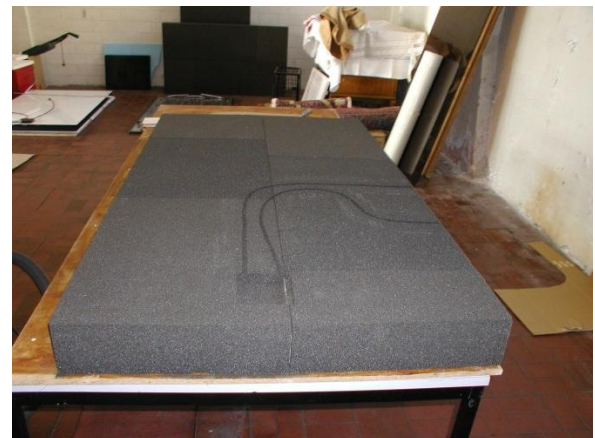
Bild 6 Kabelführung links: Vorbereitung einer Schablone für die Aussparungen, rechts: eigefräste Aussparungen (Quelle: Basler & Hofmann AG).
