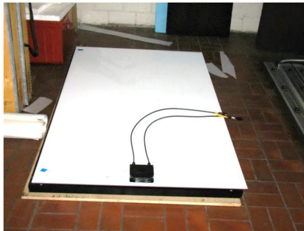
Bild 4 Gerahmtes Modul mit Tedlarrückseite in Vorbereitung für die Verklebung mit Foamglas (Quelle: Pittsburgh Corning (Schweiz) AG).
