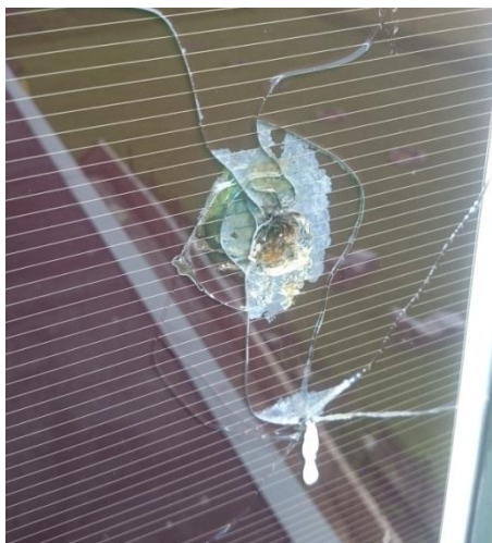
Bild 37: Beschädigtes Modul (Quelle: Basler & Hofmann AG).
