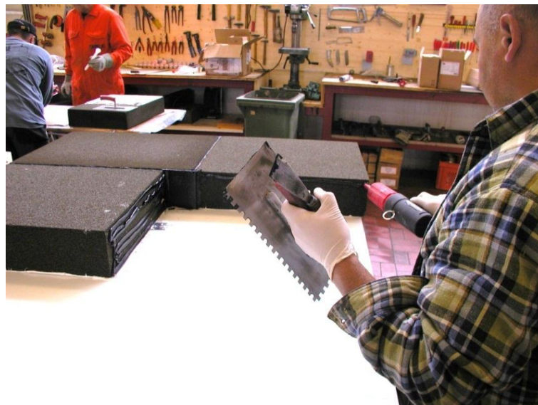
Bild 23 neue Arbeitsreihenfolge einzelverkleben der Fomaglasblöcke auf Glas-Glas Modul (Quelle: Pittsburgh Corning (Schweiz) AG).
