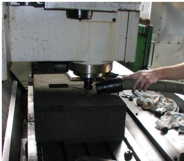
Bild 31: Maschinelle Bearbeitung des Foamglases (Quelle: Basler & Hofmann AG).
