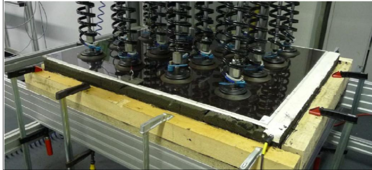
Bild 24 Erfolgreicher Zugtest, eingespanntes Glas-Glas Modul im Test (Quelle: SUPSI).
