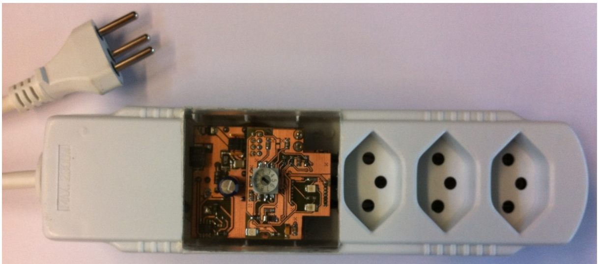
Abbildung 17: Messknoten in einer Steckerleiste
