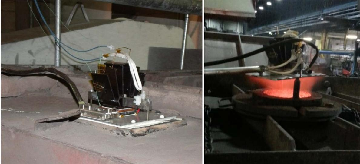
Abbildung 23: Energiewandlung mittels konduktiver Ankopplung auf dem Deckel des Schmelzofens (a) und strahlender bzw. konvektiver Ankopplung durch eine Öffnung im Deckel (b).
