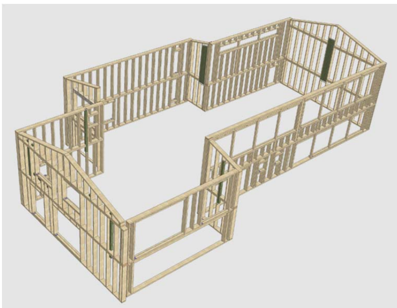
Figur 4: 3D Darstellung der grossflächigen Fassadenelemente (Rahmenkonstruktion)
