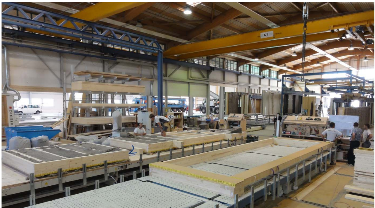
Figur 8: Die Fassadenelemente wurden Millimeter-genau vorgefertigt und mit Schafwolle gedämmt. Lüftungsrohre, elektrische Leitungen und Fenster werden fabrikseitig installiert.
