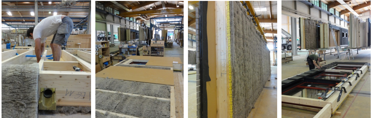
Figur 7: Fertigung der Fassadenelemente: die vorbereiteten Rahmen werden mit wärmedämmmt, die äussere Beplankung wird aufgebracht, die rückseitige duktile Dämmschicht wird befestigt, Fenster und Fassadenbekleidung werde montiert.
