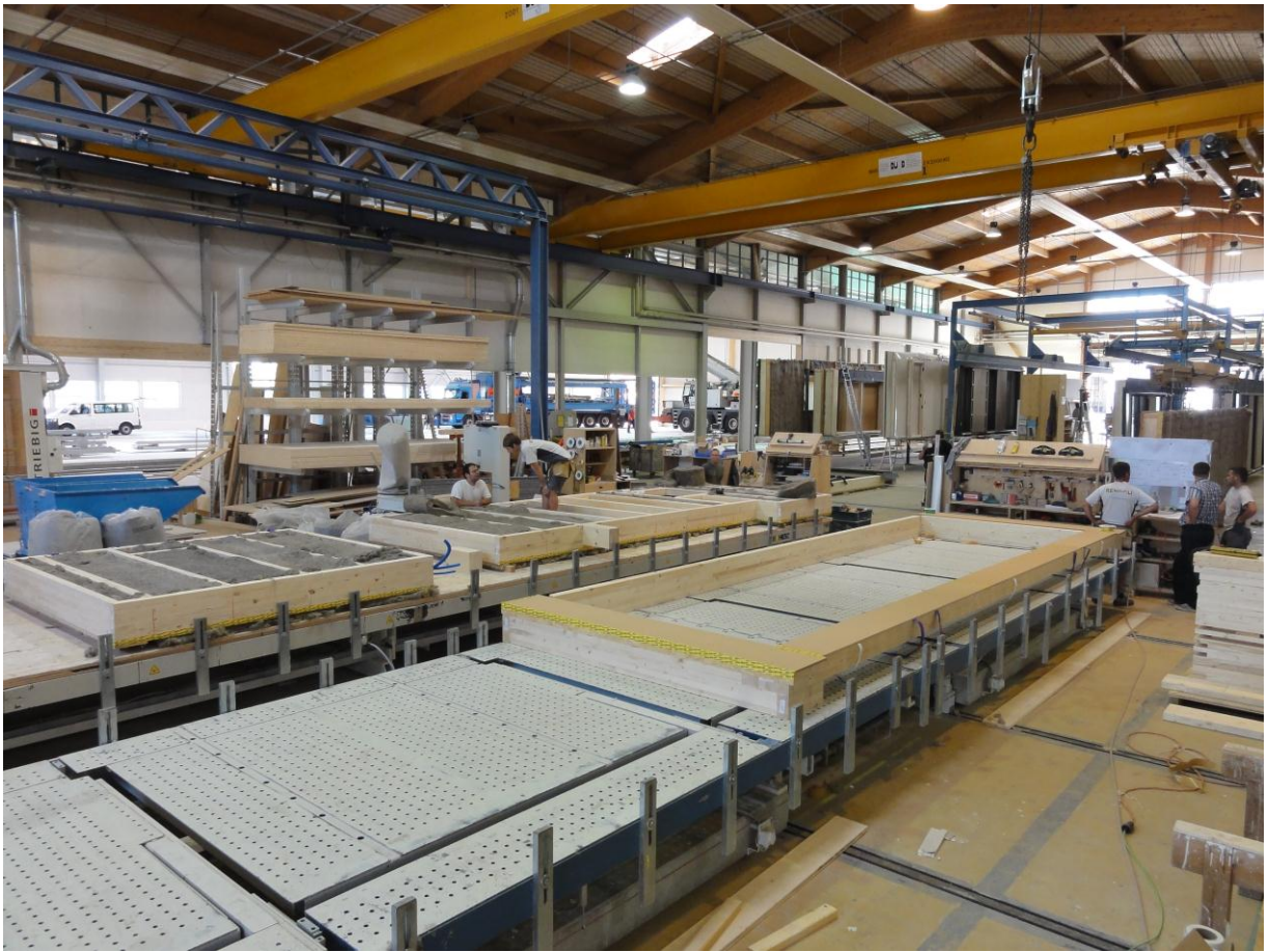
Figur 4: Die Fassadenelemente wurden Millimeter-genau vorgefertigt und mit Schafwolle gedämmt. Lüftungsrohre, elektrische Leitungen und Fenster werden fabrikseitig installiert.
