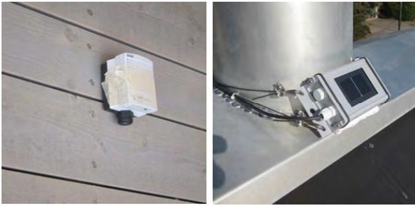
Fig 6 / 7: Messung von Aussentemperatur und Globalstrahlung
