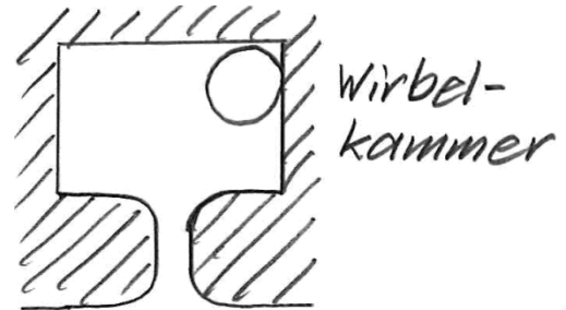
Abbildung 18: Lamellendüse mit tangentialem Eintritt in eine Wirbelkammer.
