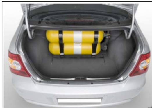
Figure 24 : Borne de distribution de Gaz Naturel pour Véhicules (GNV) à Toulouse et système de stockage du GNV dans un véhicule (Agence locale de l'Energie des Ardennes, 2009)
