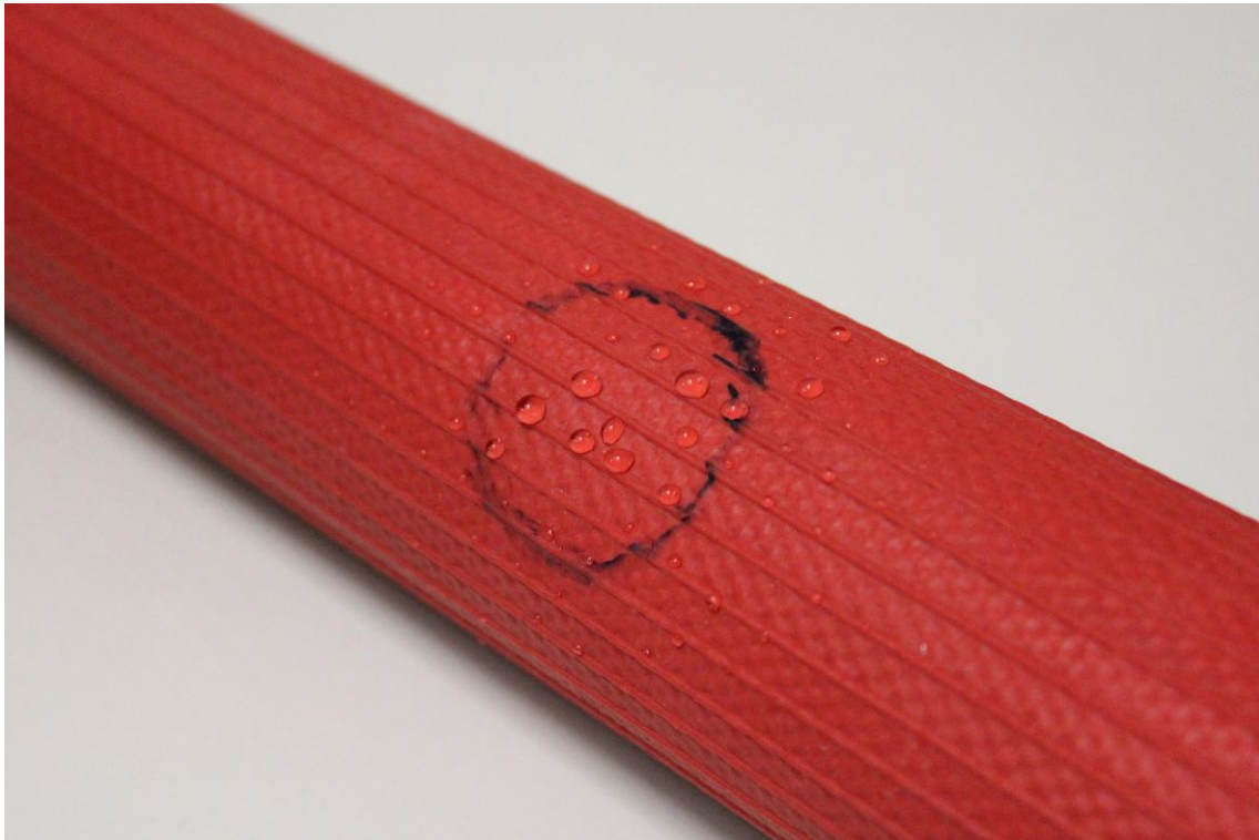
Abbildung 9: Perforiert Schlauch (drei Einstiche innerhalb des Kreises)
