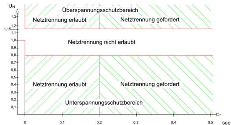
Fig. 34: Auslösekennlinie Typ A im Nieder- und Mittelspannungsnetz 13
