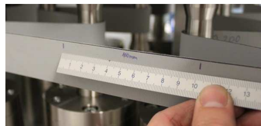
Abbildung 70: Messen der Auflagedehnung
