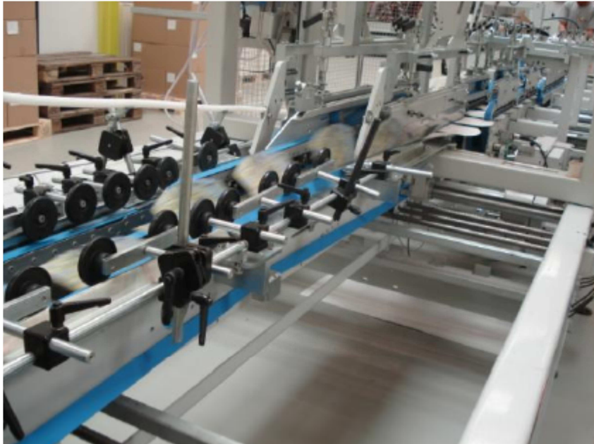
Abbildung 1: Beispiel eines Antriebsriemens auf einer Förderanlage.
