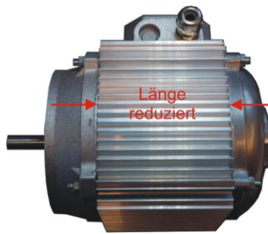
Foto 21 zeigt den Aufbau eines Permanentmagnet Motors mit Normflanschen und reduziertem Statorgehäuse, das in eleganter Weise aus einem Aluminium Strangpressprofil hergestellt ist.
