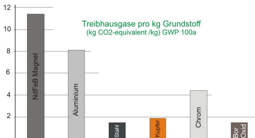
Gegenüberstellung 3: Neodym-Eisen-Bor Magnet mit technischen Grundstoffen
