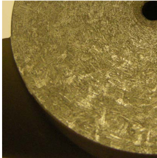
Abb. 16: Kratzer auf den unbeschichteten Anemometerschalen nach der Testsaison auf dem Gütsch.
