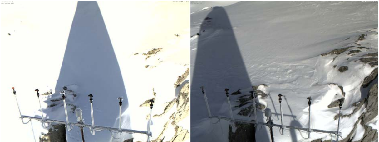
Abb. 12: Schattenwurf von Rotor (links) und Wartungshäuschen (rechts) auf die Anemometer.
