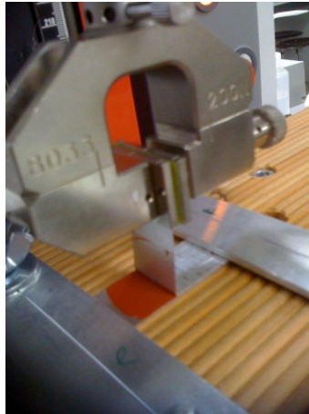
Abb. 2: Versuchsaufbau zur Bestimmung der Klebkraft.
