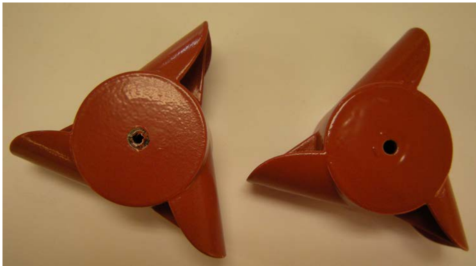
Abb. 15: Optischer Vergleich zwischen einer auf dem Gütsch eingesetzten, mit Silikonkautschuk beschichteten Anemometerschale (links) und der im Dunkeln gelagerten (rechts).
