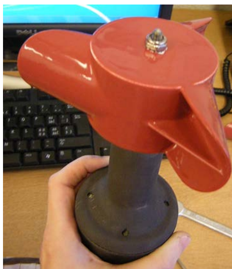
Abb. 5: Beschädigung der Beschichtung durch Montage der Anemometerschale.
