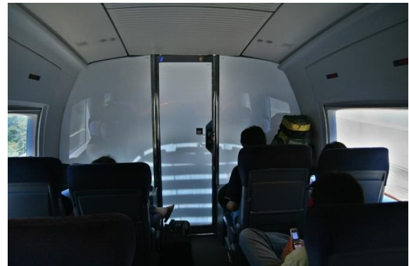
Abbildung 71: Elektrochromes Glas als Sichtschutz zur Führerkabine im ICE 3 der Deutschen Bahn im transparenten (links) und opaken Zustand (rechts)
