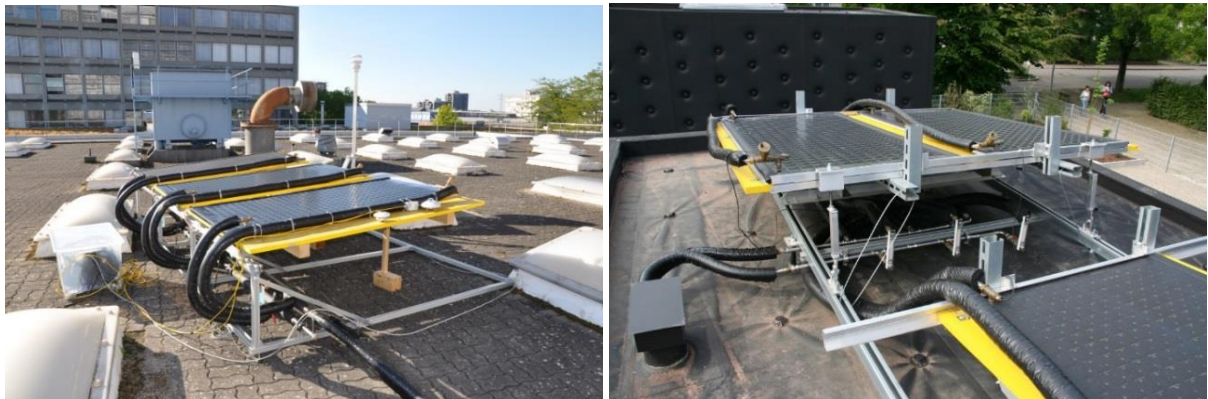
Abbildung 1: Prüfstandsmessungen der drei Absorber des Herstellers Energie Solaire SA
