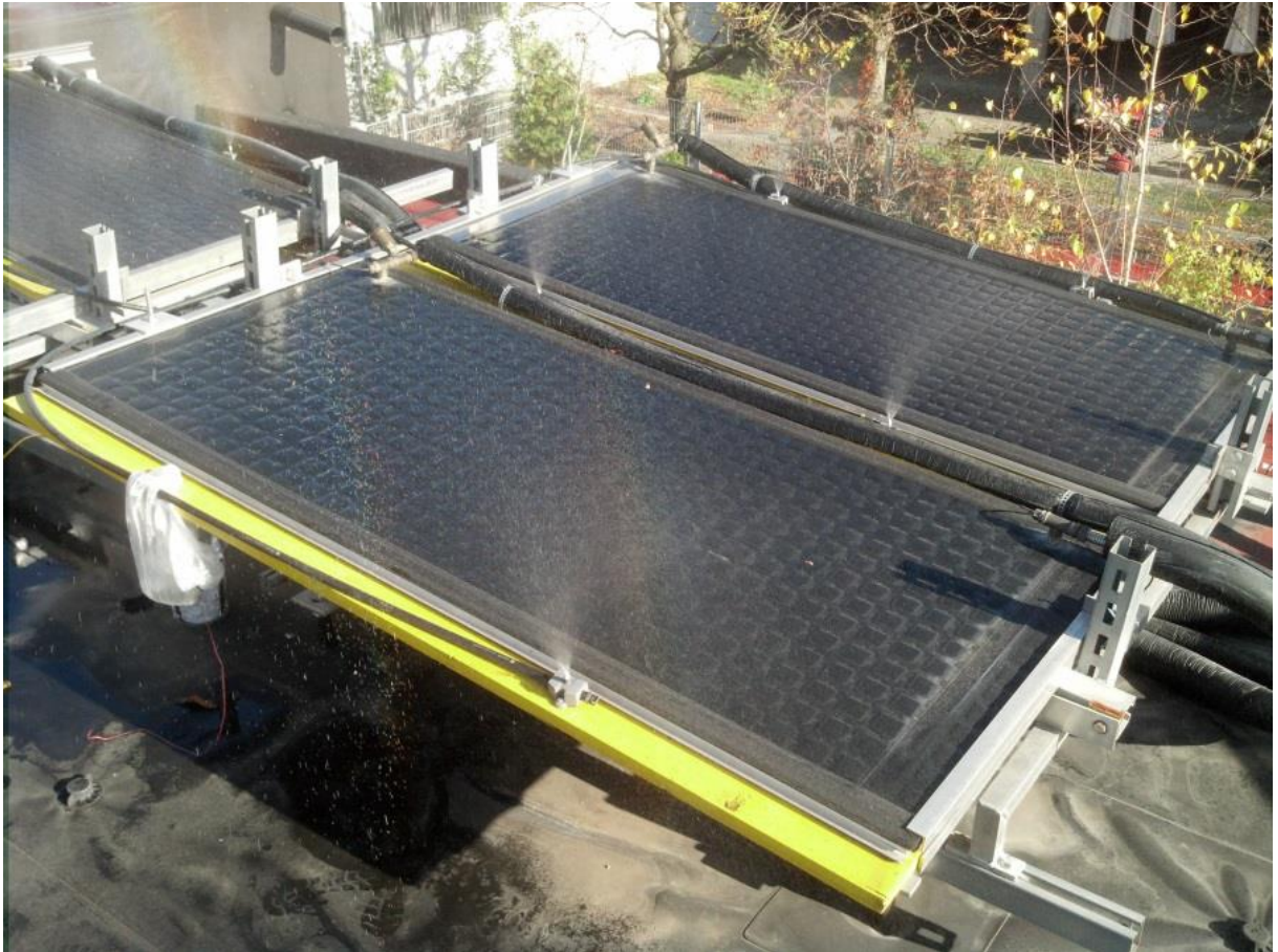
Abbildung 30: Prüfstandsmessung mit Berieselung der Absorberfläche
