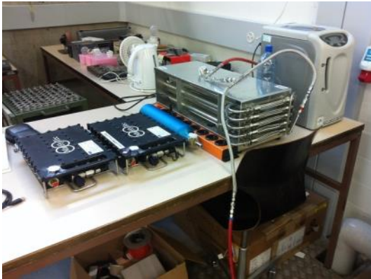
Abbildung 12 Ladestation mit Verschiedene Speichern
