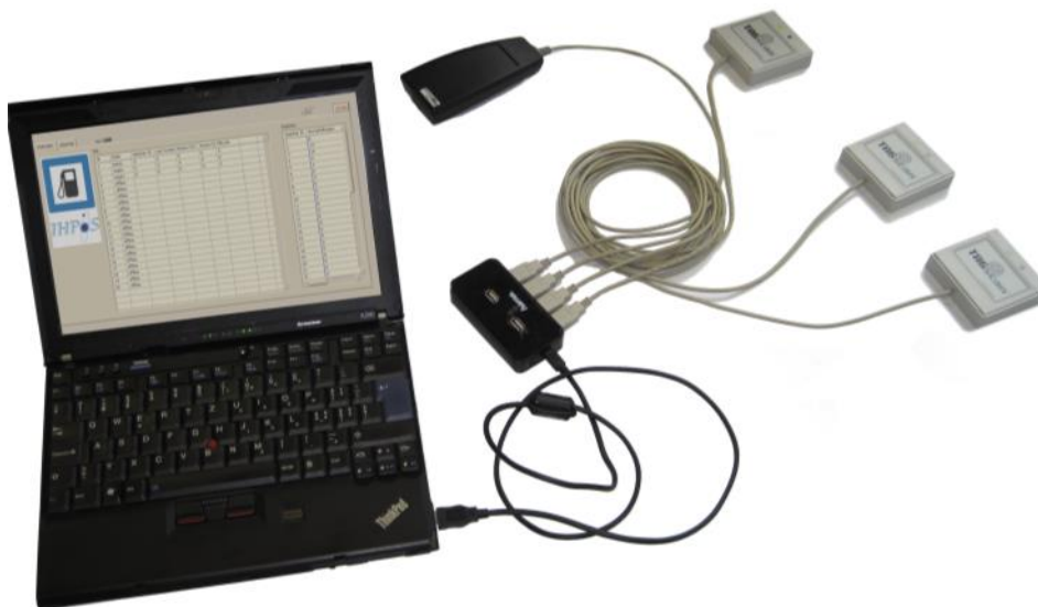
Abbildung 17 Funktionsmuster der Befüllstation mit 3 Readern und einem Handlesegerät
