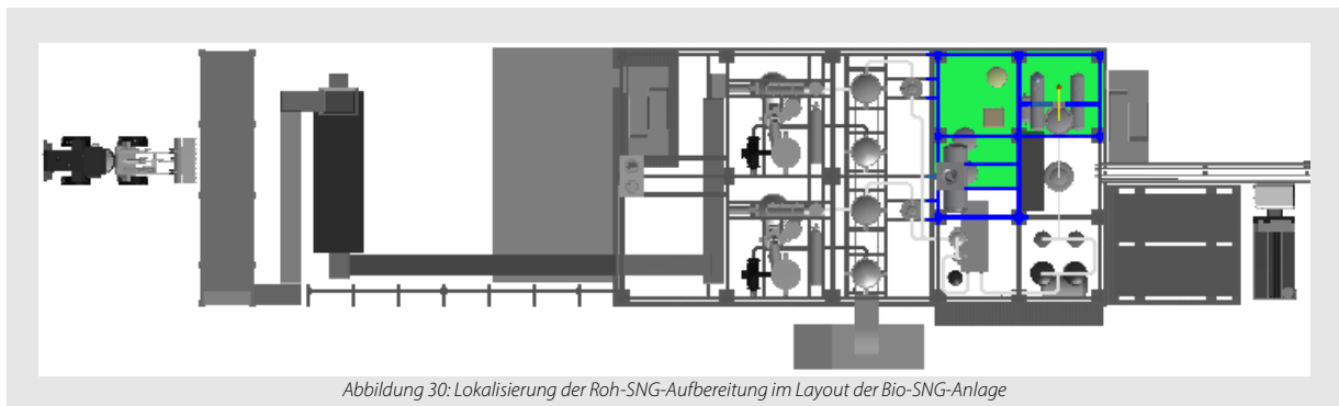
Abbildung 30: Lokalisierung der Roh-SNG-Aufbereitung im Layout der Bio-SNG-Anlage
