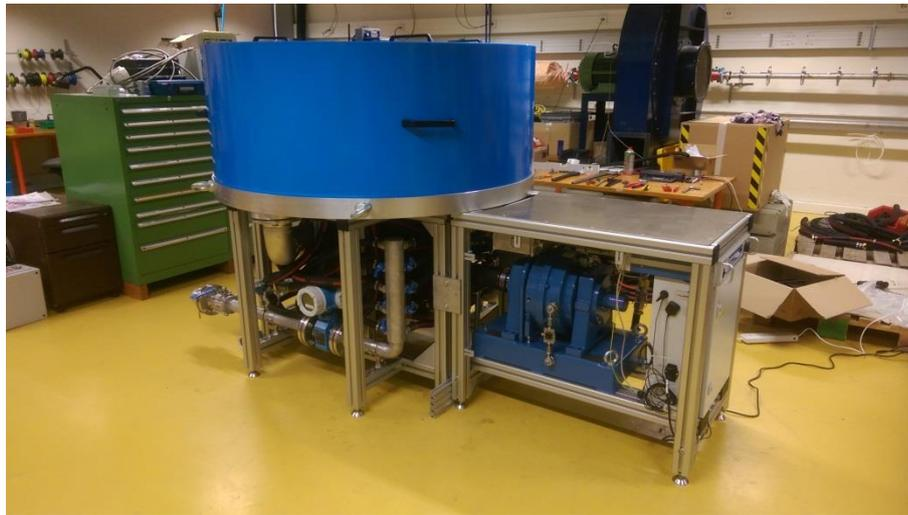
Abbildung 2: Prüfstands Aufbau mit TMM (links) und Belastungseinheit (rechts)
