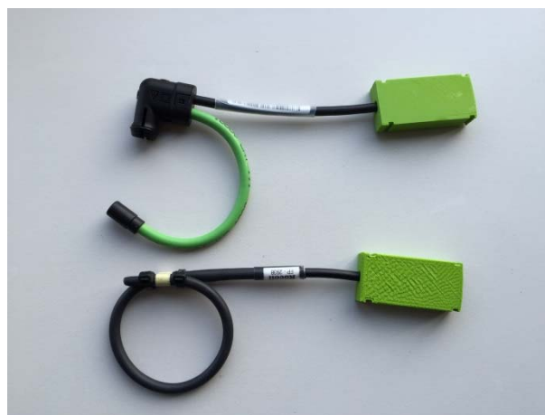
Fig. 7 Flexible Rogowski-Spulen von 3M als Weiterentwicklung der PCB-basierten Variante
