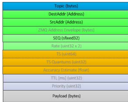
Fig. 13: Komplettes Datenformat einer GridNet Nachricht mit definiertem Header und freiem Payload. Felder mit grauem Text sind optional und werden je nach Nachrichten-Typ weggelassen.
