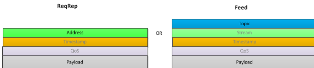
Fig. 14: Effektives Datenformat für GridNet Request-Reply und Feed Nachrichten mit definiertem Header und freiem Payload. Felder mit grauem Text sind optional.
