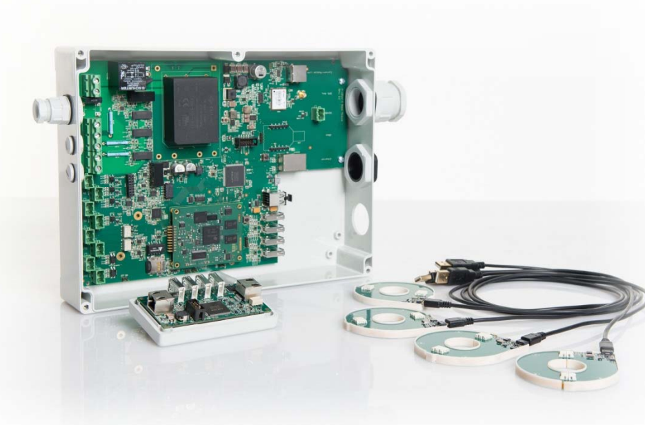
Fig. 5 GridBox Basismodul, Strommodul und Rogowski-Stromsensoren.
