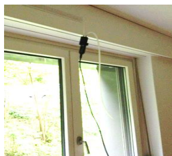
Abb. 27: Druckdifferenzmessung beim Aussenluft durchlass
