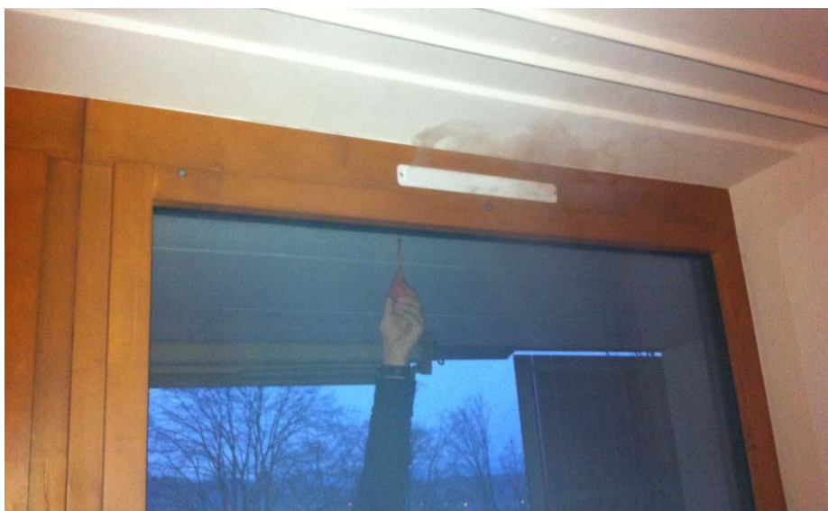
Abb. 6 : Rauchversuch am Aussenluftdurchlass im Wohnzimmer
