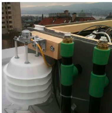
Abb. 12 Umgebungsklima. Links: Wetterstation mit Pyranometer, rechts: PVT Vor- und Rücklauf.
