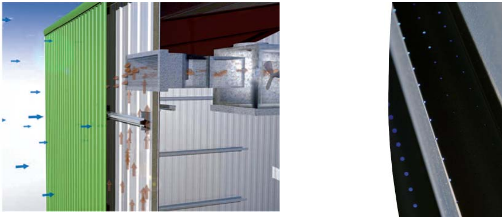
Abbildung 2: Konzept der Zuluft-Vorwärmung mittels perforierter Fassadenelemente (links) und Detailansicht des Luftkollektors COLOR-COAT RENEW SC® (rechts) (Quelle: Tata Steel/Montana AG)
