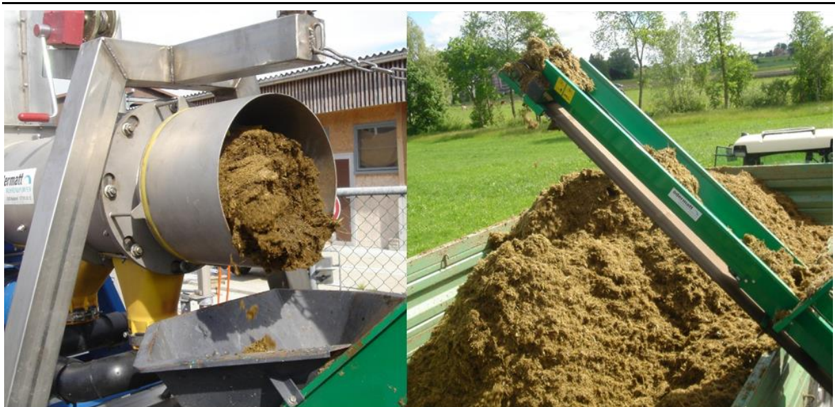
Abbildung 26: Die Siebpressschnecke (links) wird zur Separierung der Rohgülle verwendet. Die Feststoffe (rechts) werden mittels Förderband beispielsweise direkt in den Anhänger weiterbefördert.
