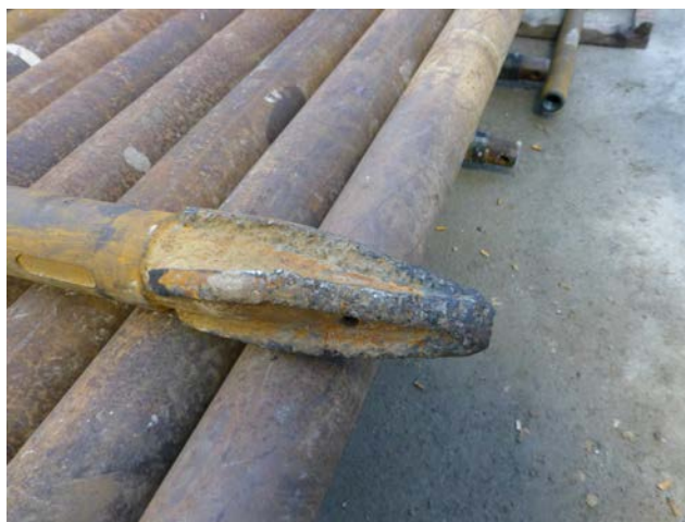
Fig. 3.9: Gebrauchter Taper Mill nach dem Ausbohren des Ball Seals
