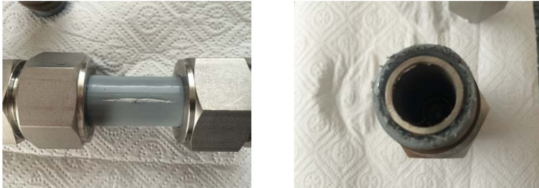
Fig. 4.4: Test des Injektionsschlauches mit Swagelock-Verbindern – Geplatzte PE100 Schutzschicht (links) und Aufsicht auf die Schnittstelle (rechts)
