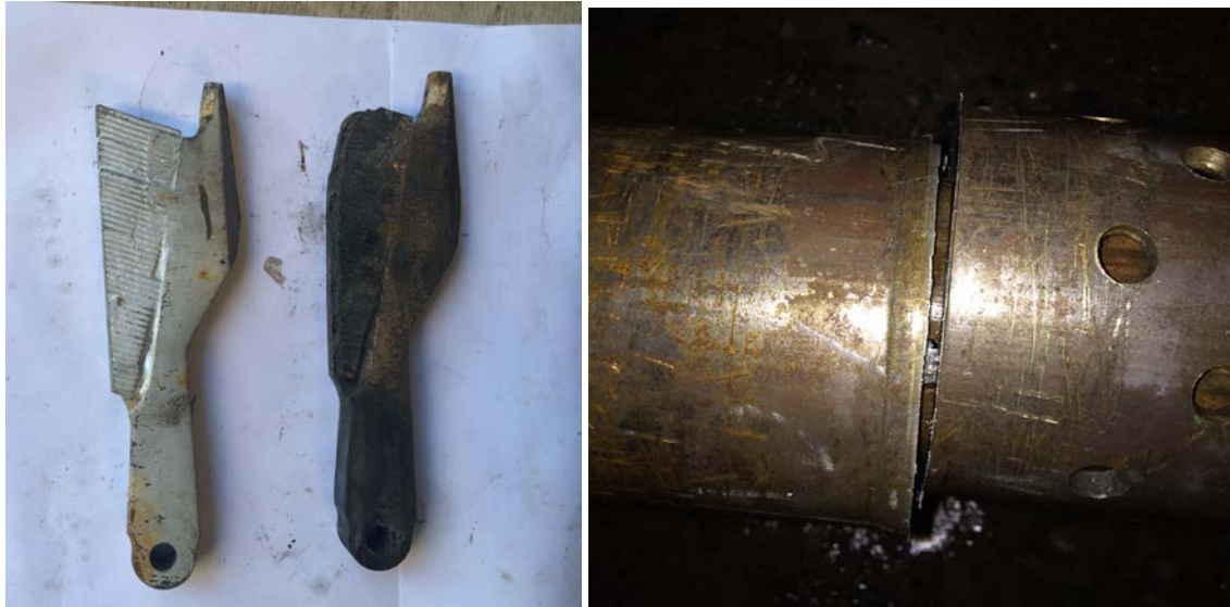
Fig. 3.11: Verschiedene Cutter Messer (links) und erfolgreicher Schnitt einer 5“-Verrohrung Übertrage (rechts)
