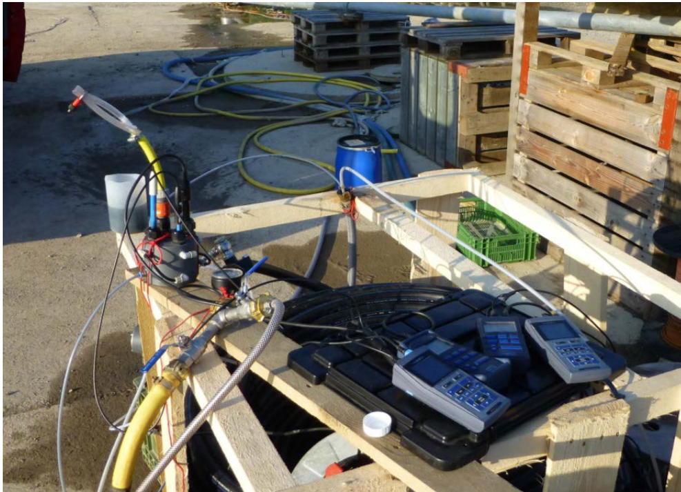
Fig. 4.3: Messung von Temperatur, pH-Wert, spez. Elektrische Leitfähigkeit und Redox-potential in einer Durchflusszelle (aus Eichinger & Frieg, 2013)
