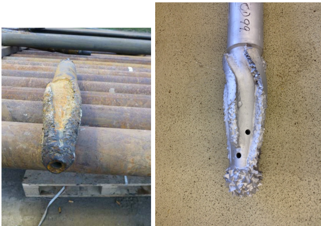
Fig. 3.10: Abgenutzter Taper Mill (links) und neuer Taper Mill (rechts) zum Befahren der Bohrlochstrecke bei 1'411 m.
