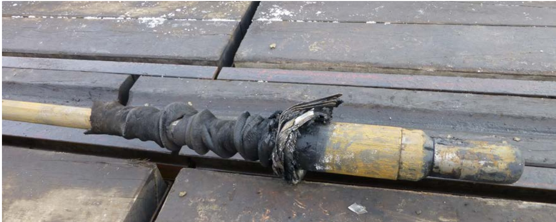
Fig. 3.15: Zerstörter unterer Packer nach dem Ausbau
