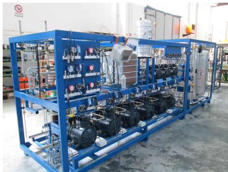
Bild 3: Verbundanlage bei der Fertigung in Italien (Quelle Enex Srl)
