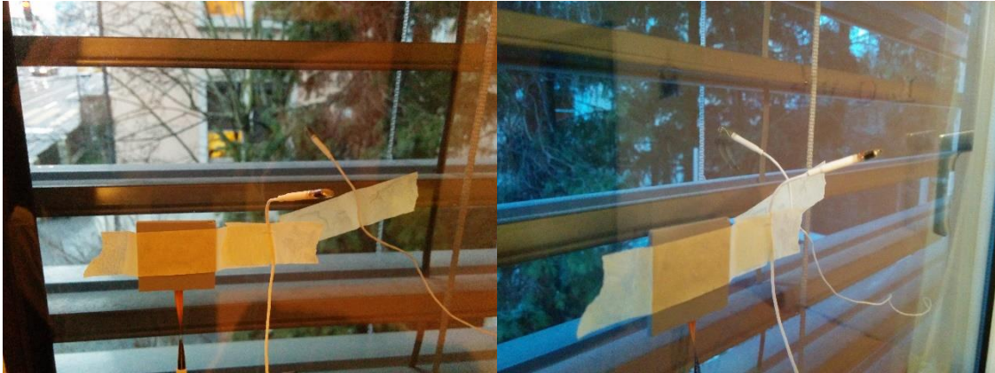
Abbildung 1: Messsaufbau; Fenster mit metallischer Sonnenblende; Wärmeflussensor mit 2 Temperatursensoren, einer innen und einer außen, beide ungefähr 3-5 cm Abstand zum Glas.
