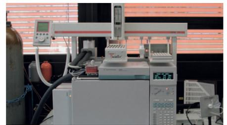
Der GC ist mit Autosampler und Kaltaufgabesystem ausgestattet. Dank auswechselbaren Probenaufgabesystemen ist er zur Analyse von Flüssigproben und Gasen geeignet.
