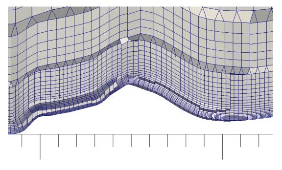
Abbildung 14: Netzbeispiel: Detailansicht des Fläscherberges in der Talgabelung bei Sargans
