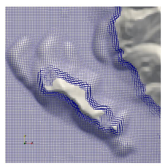
Abbildung 15: Netzbeispiel: Aufsicht auf den Fläscherberg in der Talgabelung bei Sargans. Gezeigt werden alle Zellen unterhalb von 900m ü.M.
