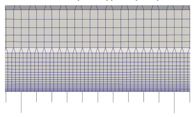
Abbildung 12: Netz in der Ebene. Das Netz wird mit zunehmender Höhe grobmaschiger.
