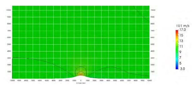
Abbildung 5: Strömung über einen Hügel ohne Auftrieb. Dargestellt ist der Betrag der Geschwindigkeit.
