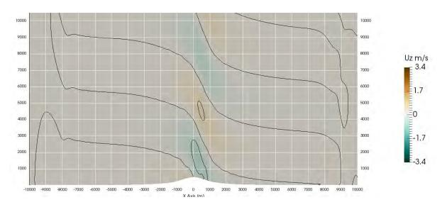
Abbildung 4: Simulation einer Gravitationswelle über einen Hügel. Dargestellt ist die vertikale Geschwindigkeit.
