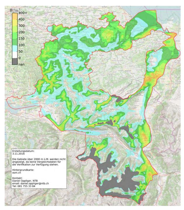
Abbildung 33: Windleistung 150m über Grund
