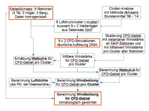
Abbildung 19: Schematische Darstellung der Prozessierungsschritte des Windkatasters
