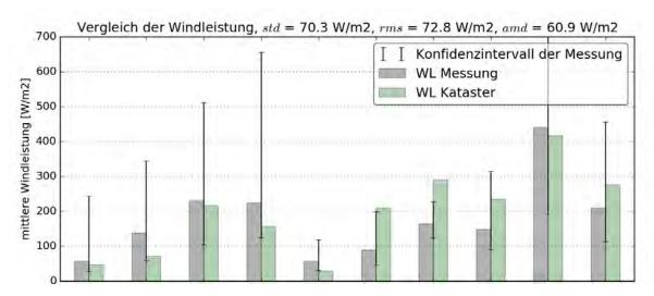
Abbildung 24: Vergleich der Windleistung mit Messwerten, elche nicht in die Methode eingeflossen sind (150m über Grund).
