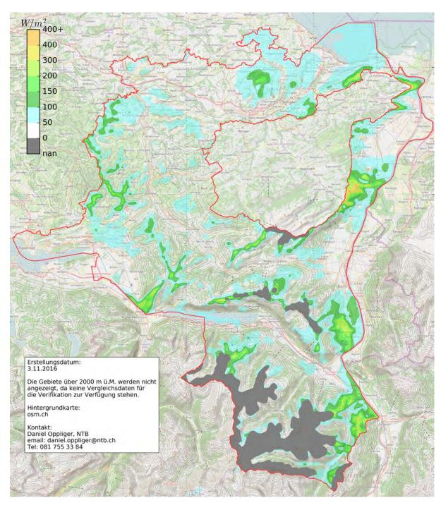
Abbildung 31: Windleistung 50m über Grund
