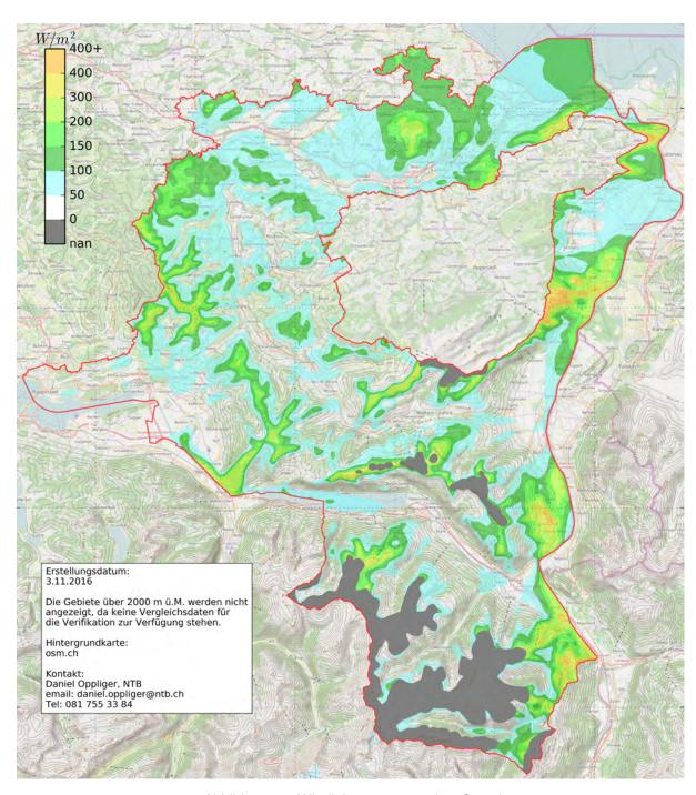
Abbildung 32: Windleistung 100m über Grund
