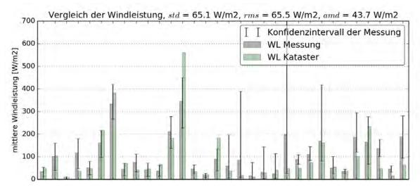
Abbildung 28: Vergleich der Windleistung auf 50m über Grund. Ein Teil der Messwerte werden in der Methode verwendet.
