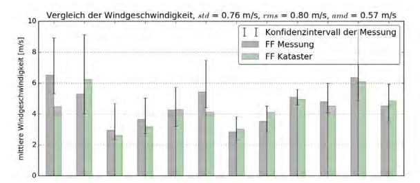
Abbildung 26: Vergleich der Windgeschwindigkeit mit Messwerten, welche nicht in die Methode eingeflossen sind (100m über Grund).
