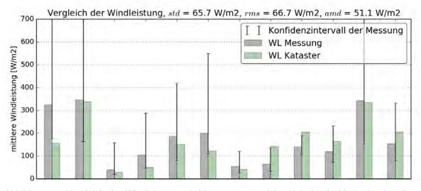
Abbildung 23: Vergleich der Windleistung mit Messwerten, welche nicht in die Methode eingeflossen sind (100m über Grund).
