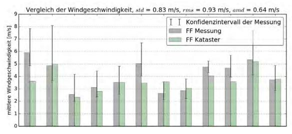
Abbildung 25: Vergleich der Windgeschwindigkeit mit Messwerten, welche nicht in die Methode eingeflossen sind (50m über Grund).
