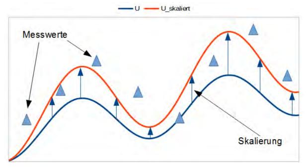
Abbildung 20: Schematische Darstellung der Skalierung des CFD-Windfelds mit einem konstanten Faktor
