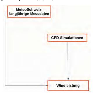
Abbildung 1: Gliederung der Methode in drei Schritte: Wetterklassifizierung der langjährigen Messdaten, CFD Simulation (Windsimulation) und Hochrechnung zur Windleistung.
