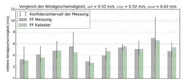
Abbildung 27: Vergleich der Windgeschwindigkeit mit Messwerten, welche nicht in die Methode eingeflossen sind (1500m über Grund).
