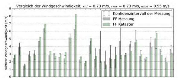
Abbildung 29: Vergleich der Windgeschwindigkeit auf 50m über Grund. Ein Teil der Messwerte werden in der Methode verwendet.
