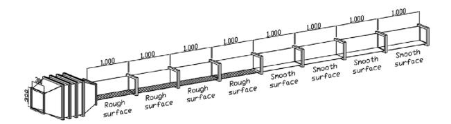
Abbildung 10: Setup zur Überprüfung der Bodenrauigkeit (aus [11])
