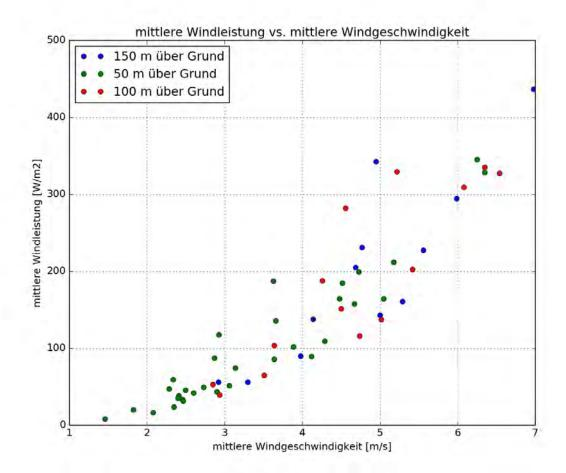
Abbildung 30: Zusammenhang zwischen der mittleren Windleistung und der mittleren Windgeschwindigkeit. Aus Messerten auf  $50\,\mathrm{m}$ ,  $100\,\mathrm{m}$  und  $150\,\mathrm{m}$  über Grund.
