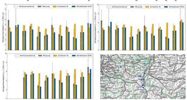
In den obigen drei Abbildungen sind die Messresultate der zwölf Messungen (graue Balken) inkl. dem Vertrauensintervall der Messungen, sowie die Resultate des Schweizer Windatlas (gelb) und des Windkatasters NTB (blau) abgebildet. Die vierte Abbildung zeigt die Position der zwölf Messstandorte (blau).
