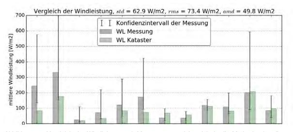
Abbildung 22: Vergleich der Windleistung mit Messwerten, welche nicht in die Methode eingeflossen sind (50m über Grund).
