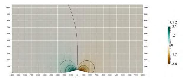
Abbildung 6: Strömung über einen Hügel ohne Auftrieb. Dargestellt ist die vertikale Geschwindigkeit.
