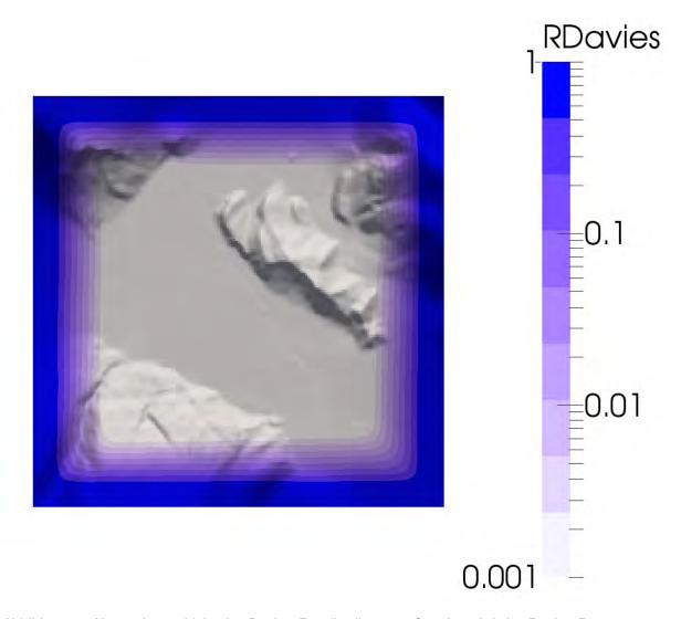
Abbildung 8: Absorptionsschicht der Davies Randbedingung. Gezeigt wird der Davies-Parameter R. Dieser ist im Innern 0 und steigt am Rand langsam gegen 1. Beachte, dass die Farbskala logarithmisch angegeben ist.
