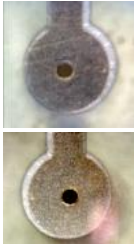
Fig. 2: Ungefüllter Hohlraum mit Füll-Loch ( \varnothing 0.3mm) oben. Hohlraum gefüllt mit IL (unten)
