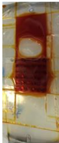
Fig. 3: Fülltechnik für die Kavitäten: das IL wird auf das Substrat aufgetragen und in eine Vakuumkammer gegeben.
