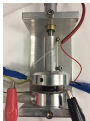
Fig. 12: Set-up der Test-Zelle zur Charakterisierung der ILs
