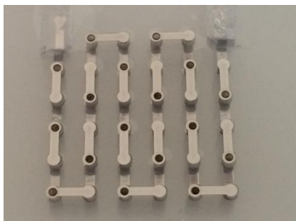
Fig. 5: TEG-Prototyp (1,5x1.5 cm) auf Silikonbasis, mit 34 Zellen in Reihenschaltung
