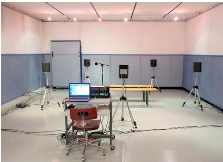
Abb. 14: Bild des Messaufbaus im semi-anechoischen Labor der Empa.
