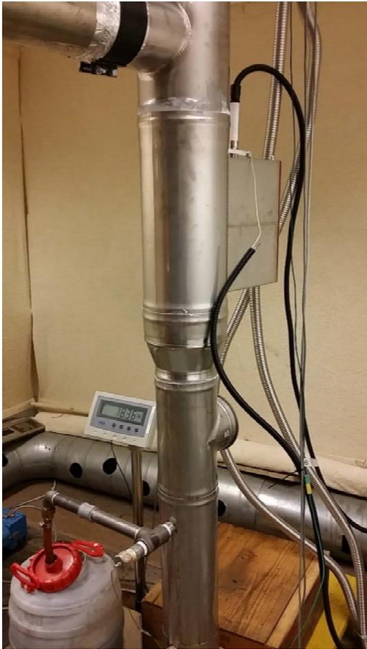
**Abbildung 5.2.1.2.:** Die Waage misst alle 10 Sekunden die Menge des Kondensats, das durch das Rohr in den Kondensatbehälter fließt.
