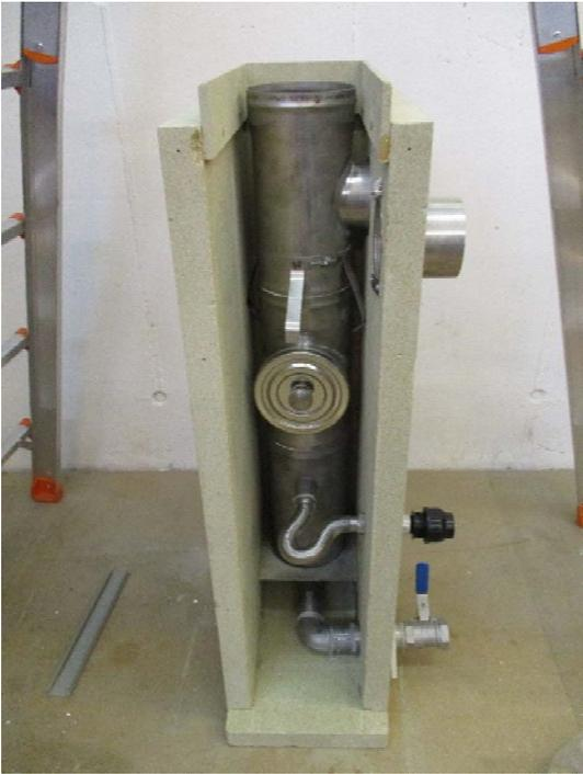
**Abbildung 6.6.1.:** Das Unterteil vom NOSMOG enthält den Kondensatbehälter mit der Entleerungs-, Überlaufleitung und Kontroll/Putzöffnung.
