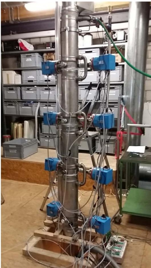
**Abbildung 6.5.3.:** Fünf Opazimeter sind auf der Elektrofilterstrecke mit einem Abstand von 500 mm angebracht .
