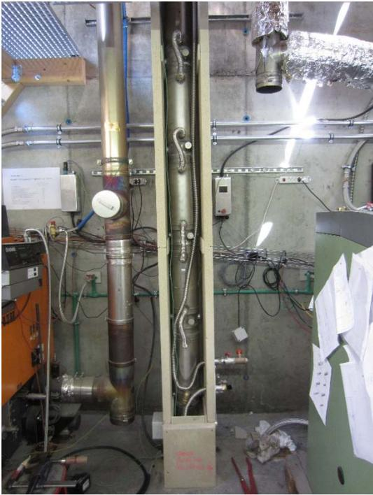
**Abbildung 6.6.2.:** Der doppelwandige Abgasrohr-Wärmetauscher
