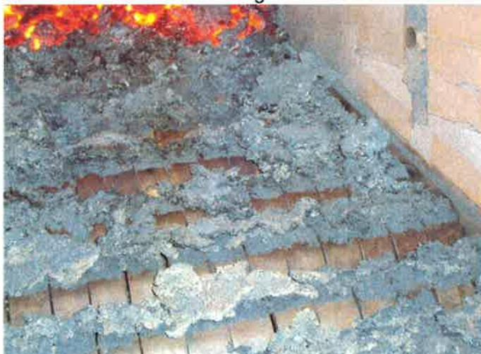
Die während der Versuche angefallenen Schlackepartikel bereiten bei entsprechender Ausführung der ascheführenden Komponenten keinerlei Probleme. Besonders bei einem angestrebten Mischungsverhältnis von 50% Energieanteil kann unter moderater Verschlackung auch der Glühverlust niedrig gehalten werden.
