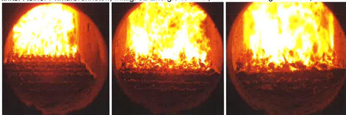
Bei MNP-Anteilen >50 Energie % werden vermehrt „Brocken“ in der Größenordnung von 100mm gebildet, die von der kontinuierlichen Schüttung abgetrennt werden.
