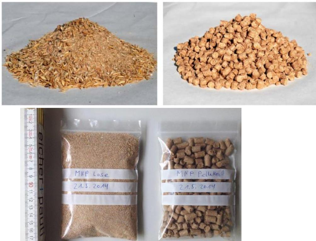
Bild 2 Müllerebenenprodukte (MNP) nach Anfall im Mahlprozess (links) und als Pellets (rechts) aus zwei unterschiedlichen Chargen (oben und unten).
