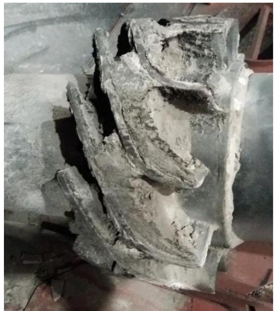
Bild 25 Ablagerungen im Abgaskanal nach dem Betrieb mit MNP-Pellets. Links: Wärmeübertrager-Rohre auf der Eintrittsseite des Heisswasser-Economizers mit verstopften Zwischenräumen. Rechts: Leitschaufeln aus dem Einlauf eines Zyklons im Multizyklon.
