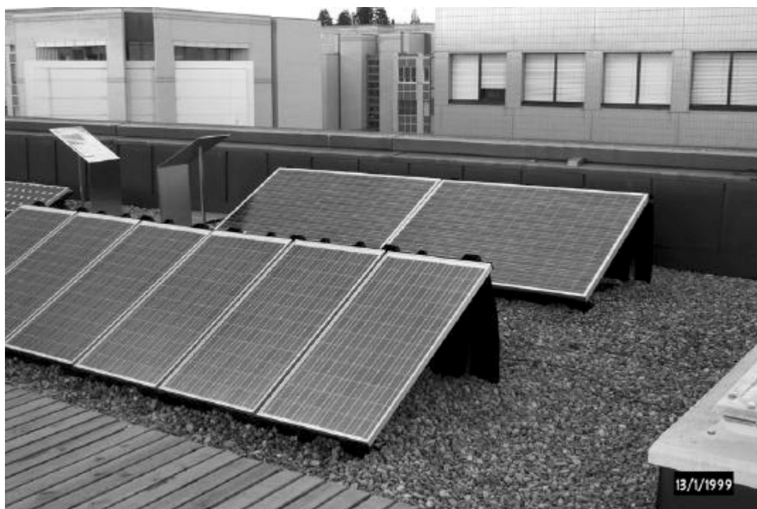
Fig. 5: Le stand de démonstration SolMax au Demosite à Lausanne permet de vérifier la tenue mécanique de l'ensemble, de tester la durabilité et de faire connaître le produit au public cible. Les deux SolMax de la première ligne sont équipés de 6 modules ASE verre-Tedlar à cadre de 100W. Les deux SolMax de la deuxième ligne sont équipés de modules ASE verre-verre à cadre de 300W. Le stand totalise une puissance de 1200W, soit 300 W par socle.
