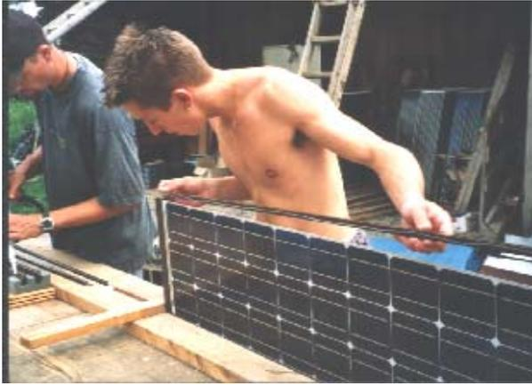
Das Laminat wird in das vorbereitete „L“ - bestehend aus Seitenprofil und Profil oben - eingesetzt. Anschliessend wird das rechte Profil angesetzt und verschraubt.
