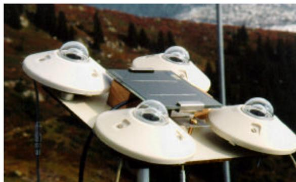
Fig. 16.2.3: Anordnung der Sensoren während des Kalibriervorganges: Referenzpyranometer (oben links), ESTI-Zelle (Mitte) und drei Feldpyranometer. Das Bild entstand in Disentis-Caischavedra während der Kalibriermessung vom 18. September 1996.
