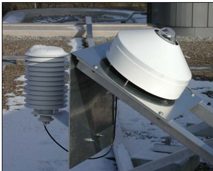
Bild 6: Referenz-Meteomessung der HTA Burgdorf. Erfassung der Einstrahlung in Generatorebene mit beheiztem Pyranometer. Erfassung der Umgebungstemperatur. Des Weiteren Erfassung der Modultemperatur der 3 Solargeneratoren (auf diesem Bild nicht erkennbar!).
