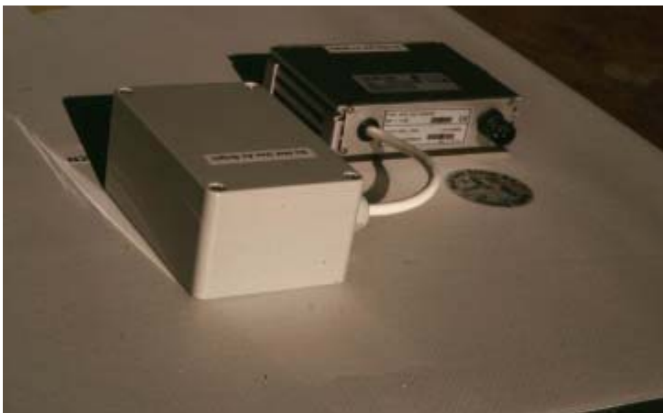
Figure 69: l'installation électrique est réduite au strict minimum grâce à l'équipement des modules en mini-onduleurs.
