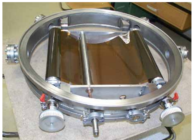
Figur 10: Roll-to Roll/Einsatz mit Linearelektrode (Konfiguration A).
