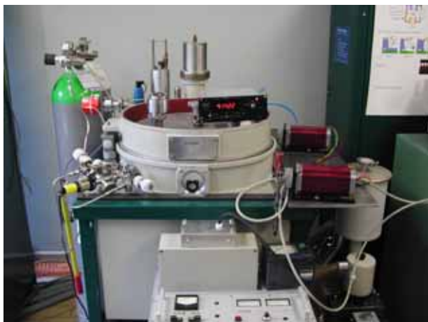
Figur 9: A550 VKZ Leybold RIE Maschine des EIAJ.
