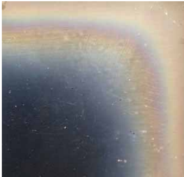
Figur 2: Plasmabehandeltes Polyimidsubstrat 40 mm x 40 mm, das mit Aluminium beschichtet wurde. Herstellungsbedingungen: Reactive Ion Etching, SF_6/O_2 atm. ( SF_6/O_2=0.33/0.67 ), Druck: 0.15 mbar, Ätzzeit: 15 min., Metallisierung: 1600 Å Aluminium, aufgedampft.
