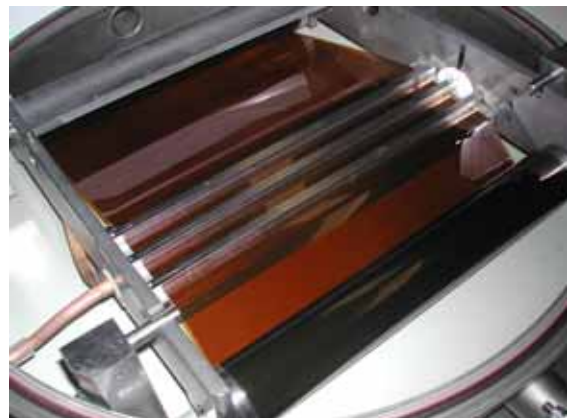
Figur 13: Flächige Ätzelektrode, Untenansicht, mit 3 HF-Stäben (Konfiguration C)
