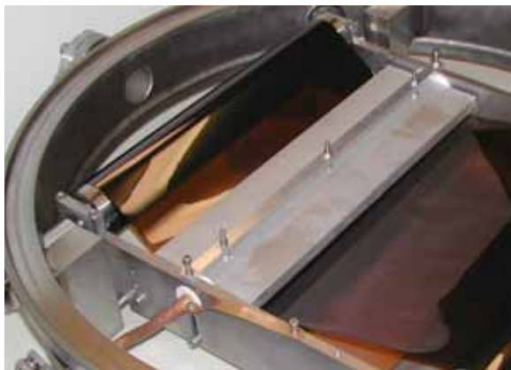
Figur 12: Flächige Ätzelektrode 35 cm x 8 cm (Konfiguration C)
