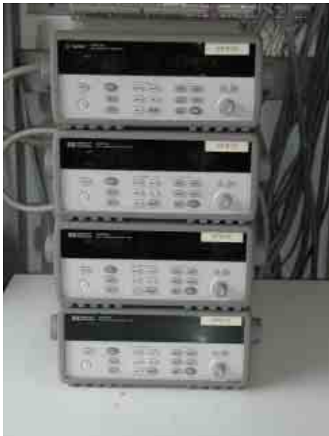
Figura 15: Datalogger Agilent (ex HP) tipo 34970A
