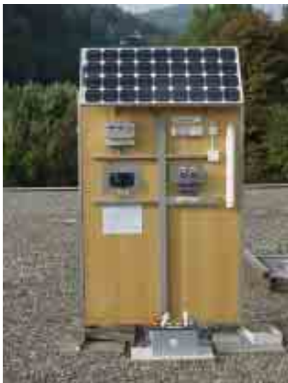
Figura 75: Impianto Stand alone 12V DC, con regolatori di carica (postazione 2)
