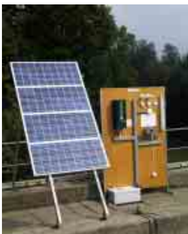
Figura 77: Impianto stand alone di potenza 230V AC, con ondatore DC/AC (postazione 4)
