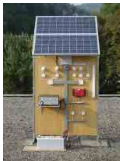
Figura 75: Impianto Stand alone 12V DC, con regolatori di carica (postazione 2)
