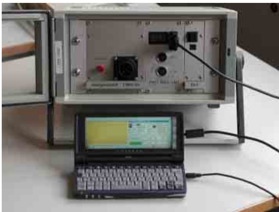
Figura 12: I-V tracer PVCT con Handheld PC.
