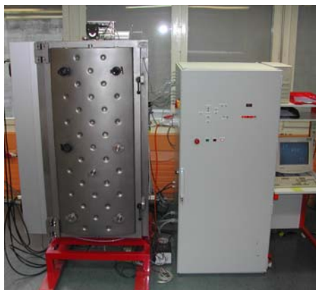
Figure 12: Machine de pulvérisation cathodique (PVD) roll-to-roll
