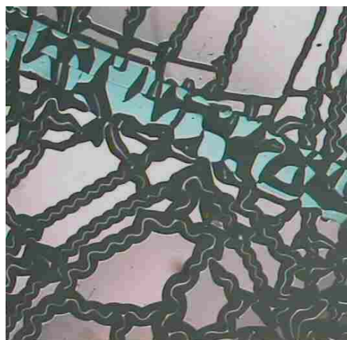
Figure 2: Photo microscopique d'une zone de cellules flexibles de VHF-Technologies sur 3x3 mm fortement délaminée, après 270 cycles -40..+85 C @ 85% RH (polyimide métallisé par Steiner GmbH).
