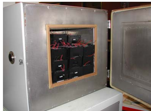
Figure 6: Chambre de cycle thermique "Vötsch" de l'EICN. Une humidité saturée est réalisée par la présence d'un bac d'eau ouvert dans l'enceinte.
