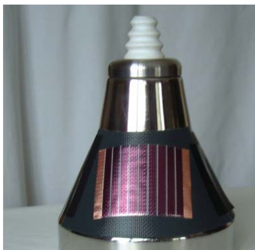
Figure 1: Parafoudre électronique équipé de cellules flexibles de VHF-Technologies sur 3x3 mm auquel un effet de délamination a été observé à la fin de l'année 2002.
