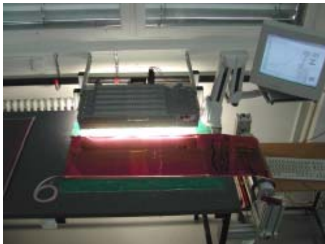
Figure 19: Table de préparation des modules, avec simulateur planaire à tubes néon.
