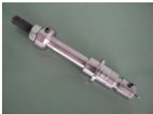
Figure 14 : Gauche: pointe de rayure mécanique avec force réglable et ressort long; droite: essais de rayures mécaniques.
