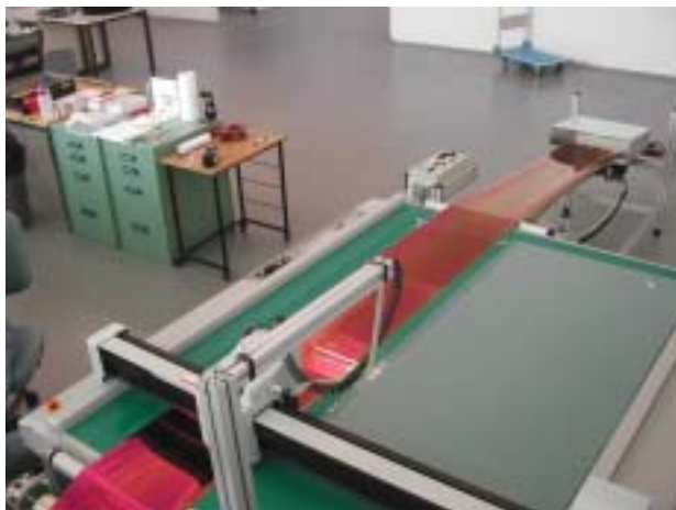
Figure 7: Back-end (Yverdon): plotter X-Y pour la mise en série (scratch + pâte) des modules solaires. La qualité (rendement de production) et la capacité de cette étape seront améliorées dans les WP5 et 6.
