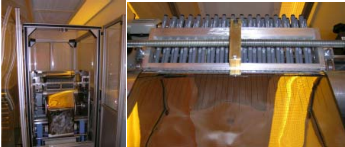
Figure 12 et 13 : Machine de bobinage avec unité de traçage intégrée; droite: détail de la tête de traçage réglable
