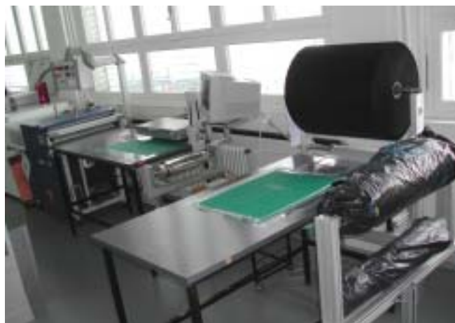
Figure 18: Table aspirante de découpe de films (premier plan), et table de préparation (arrière): surfaces vertes = surfaces d'aspiration).
