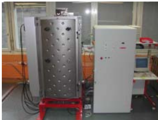
Figure 6: Front-end (Le Locle): réacteur de pulvérisation cathodique. Dans ce projet, la capacité de production sera augmentée de 200% pour la fabrication de la métallisation (WP1), et de 100% pour la fabrication de l'ITO (WP3).
