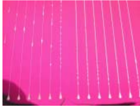
Figure 15 : essais de dispense de pâte d'argent à différentes vitesses
