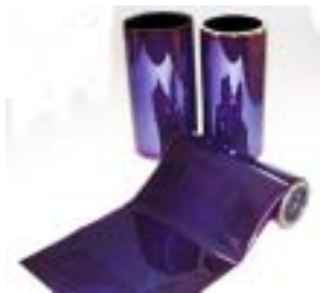
Figure 1 : Cellules solaires brutes sur film polyimide 30 cm de large (état après dépôt ITO)
