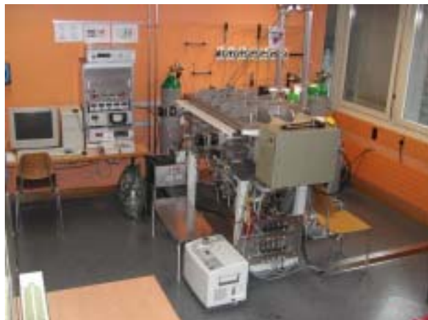
Figure 5: Front-end (Le Locle): réacteur plasma-CVD VHF pour le dépôt de silicium amorphe en roll-to-roll. La capacité de ce réacteur sera augmentée de 150% dans le présent projet (WP2).
