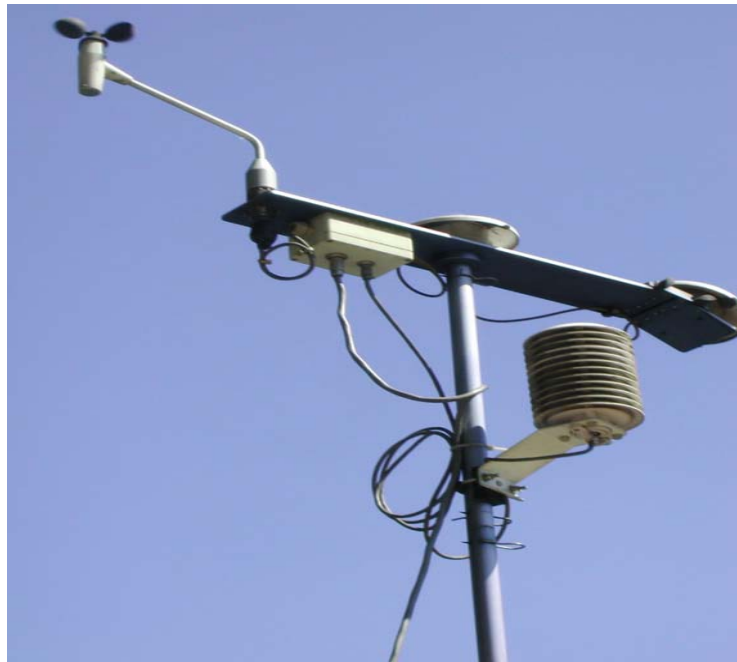
Figure 5 - le système de mesure a été réparé par Solstis et remis en route
